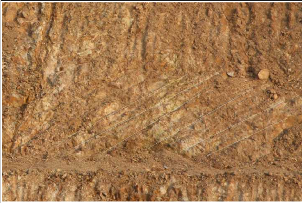
【그림 23】 B 영역 상세사진 (조밀하게 발달한 불연속면)
